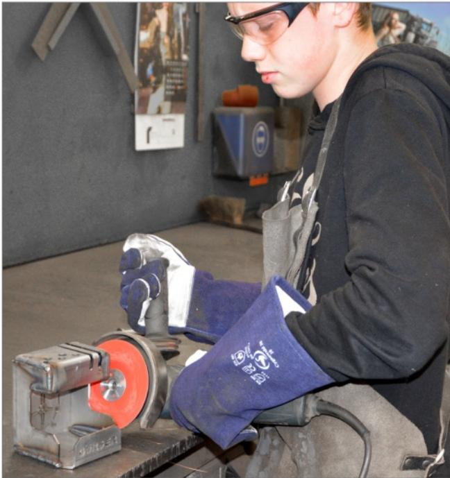
Mit dem Winkelschleifer werden scharfe Kanten geglättet.
