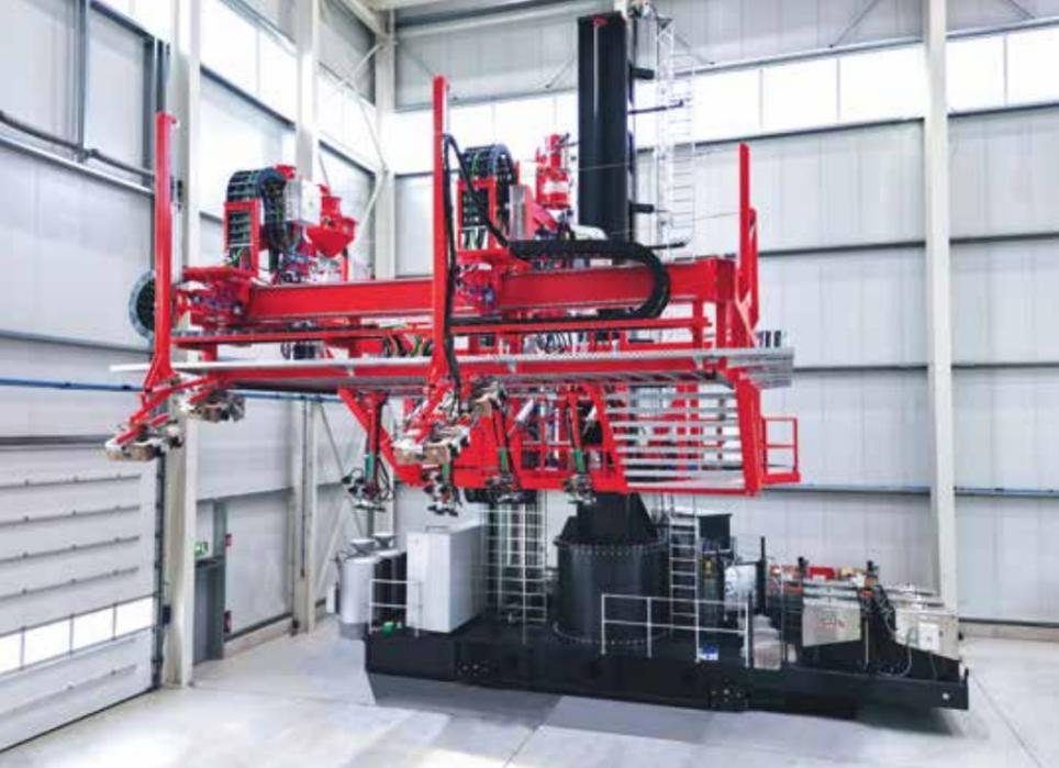
„King Kong“ lautet die inoffizielle Bezeichnung für diese Schweißstation. Das Besondere daran ist, dass zwei Schweißköpfe synchronisiert arbeiten. HAANE fertigt aufgrund einer hauseigenen Software auch Anlagen, die bis zu vier Schweißköpfe gleichzeitig zum Einsatz bringen, was bisher einmalig auf der Welt ist.
