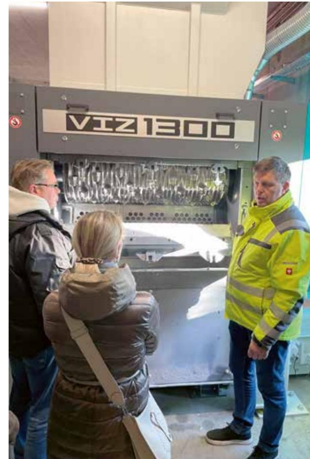
Heiner Brokamp zeigt den Gästen die Scheidekrone, das Herzstück der Anlage. Die scharfen Messer sind hoch wirksam, aber auch sehr gefährlich. Deshalb ist die Abdeckung bei Betrieb der Anlage stets verschlossen und wurde hier nur zu Demonstrationszwecken geöffnet.
